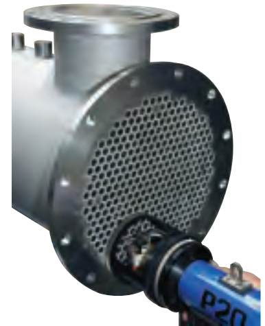
Automatisiertes Schweißen des Rohrendes und 100% Kontrolle.
